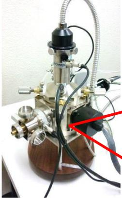
電子線透過膜を有するMEMS液体セル
